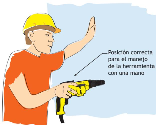
Figura 2 Forma correcta de sujetar el atornillador eléctrico con una mano
